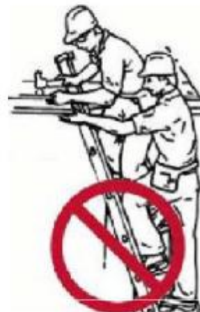
شکل ۱۲- استقرار همزمان دو نفر ممنوع
