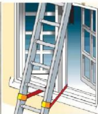
شکل ۸- نحوه تکیه‌گاه فوقانی نردبان یک طرفه
